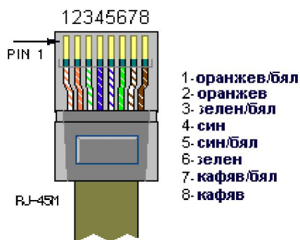
Фигура 2: Схема на конектор RJ45
